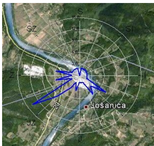
Slika br. 2: Grafički prikaz smjera rasprostiranja vjetra u odnosu na tačku mjerenja na lokaciji planiranog hidrenergetskog sistema HE „Paunci“ za mjerni period 11./12.08.2014. god.
